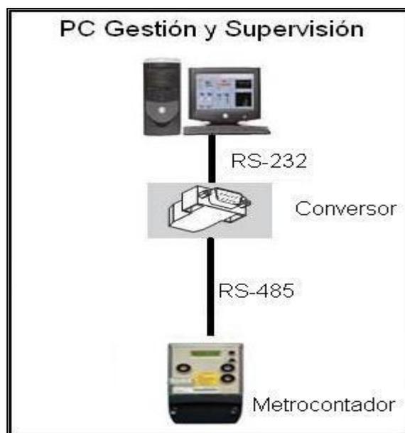
Figura 3.5: Esquema de la instalación realizada en la Facultad de Ingeniería Eléctrica.
