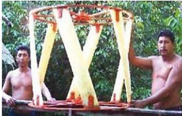
Figura 1-7: Turbina tipo Gorlov utilizada en el río Amazonas en Brasil (Anderson S. , 2009)
