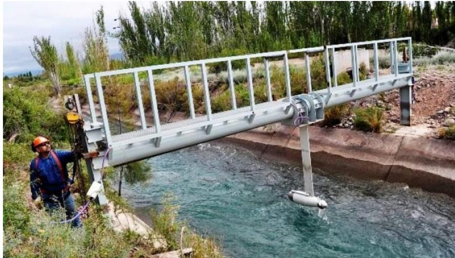
Figura 1-8. Turbina hidrocínética de la firma INVAP
