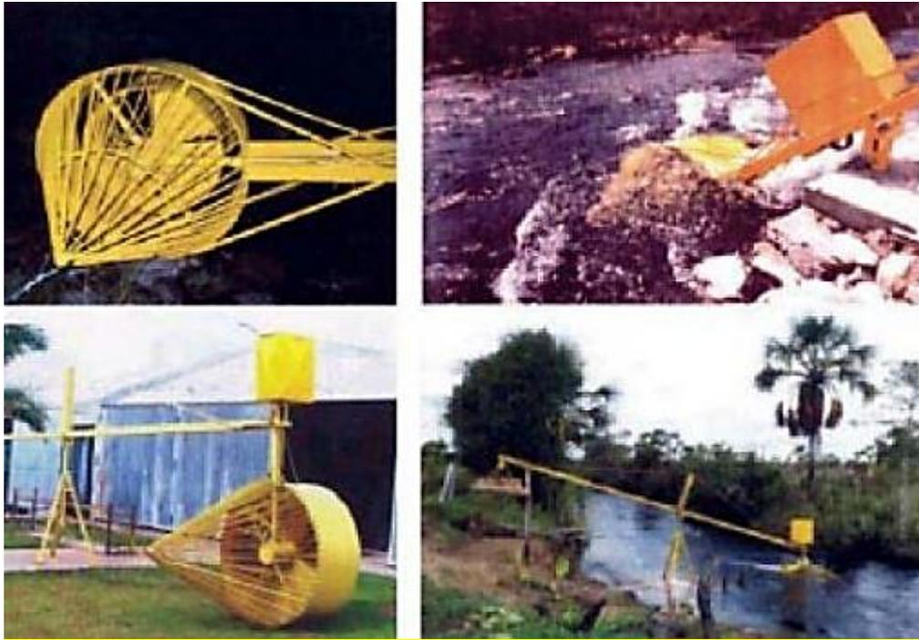
Figura 1-6: Modelos instalados de turbinas desarrolladas por la UNB para los experimentos de campo (Tiago F, 2003)
