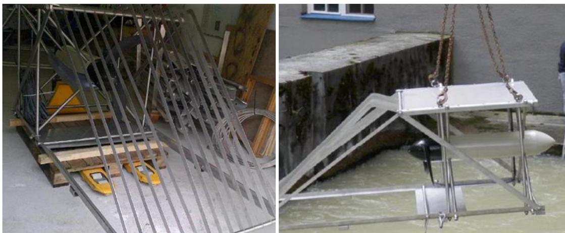
Figura 1-9: Turbina hidrocínética de la firma Smart Hydro Power
