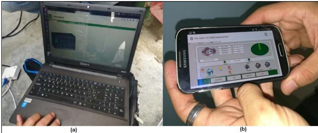
Figura 3-12 Visualización remota del servidor web durante la prueba experimental de comunicación remota. a) Sitio web predefinido del PLC. b) Interfaz de control “Panel” visualizada desde un dispositivo móvil durante la prueba.
