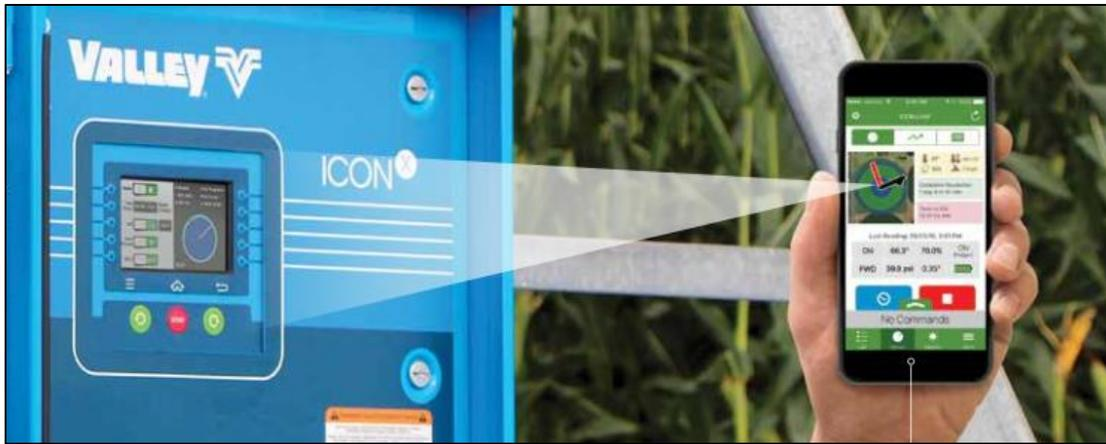
Figura 1-6 Panel de Control Inteligente con tecnología de control remoto y aplicación móvil de la compañía Valley Irrigation (Valley-Irrigation, 2018a)
