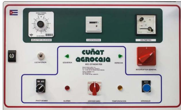
Figura 2-3 Panel de control de máquina de riego de pivote central de la firma Reductores Cuñat
