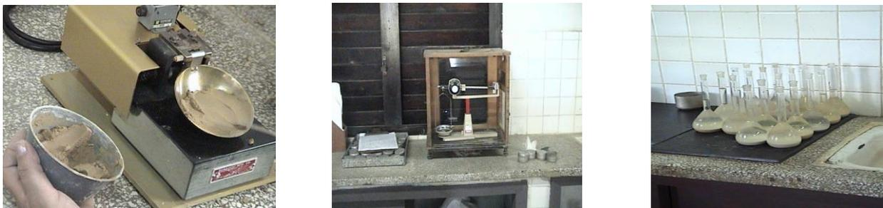
**Fig. 2.1. Equipamiento utilizado para la determinación de las propiedades físicas del suelo objeto de estudio.**
