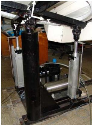
Figura. 2: Plataforma neumática de simulación de 2 GDL
