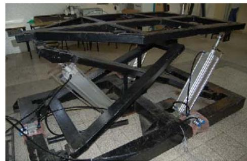
Figura. 3: Plataforma neumática de simulación de 3 GDL
