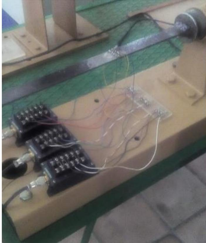
Fig 3.4. Montaje de los tres puentes necesarios para la medición con la roseta.
