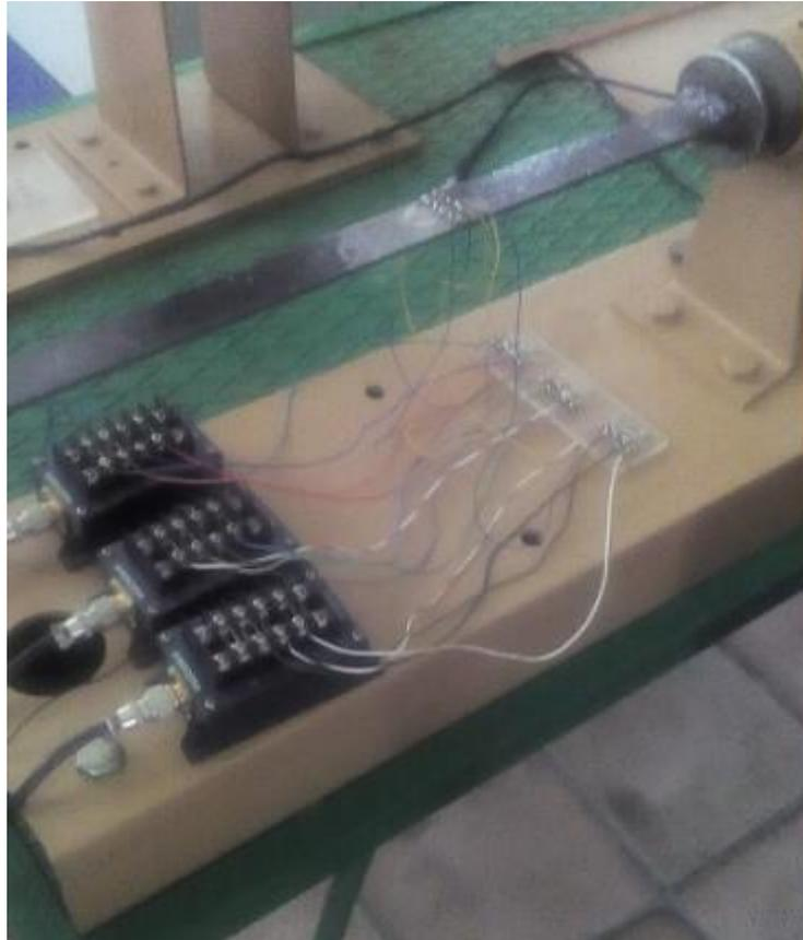
Fig 2.2. Montaje de los tres puentes necesarios para la medición con la roseta.
