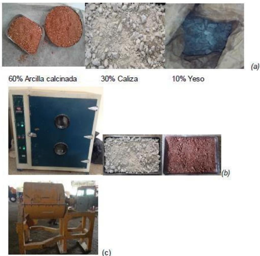
Figura 2.5 a), b) y c) Proceso de producción de LC<sup>2</sup>
