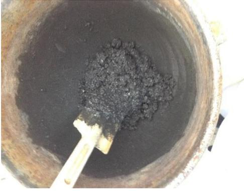
Figura 2.1 Proceso de amasado del cemento con los aditivos.
