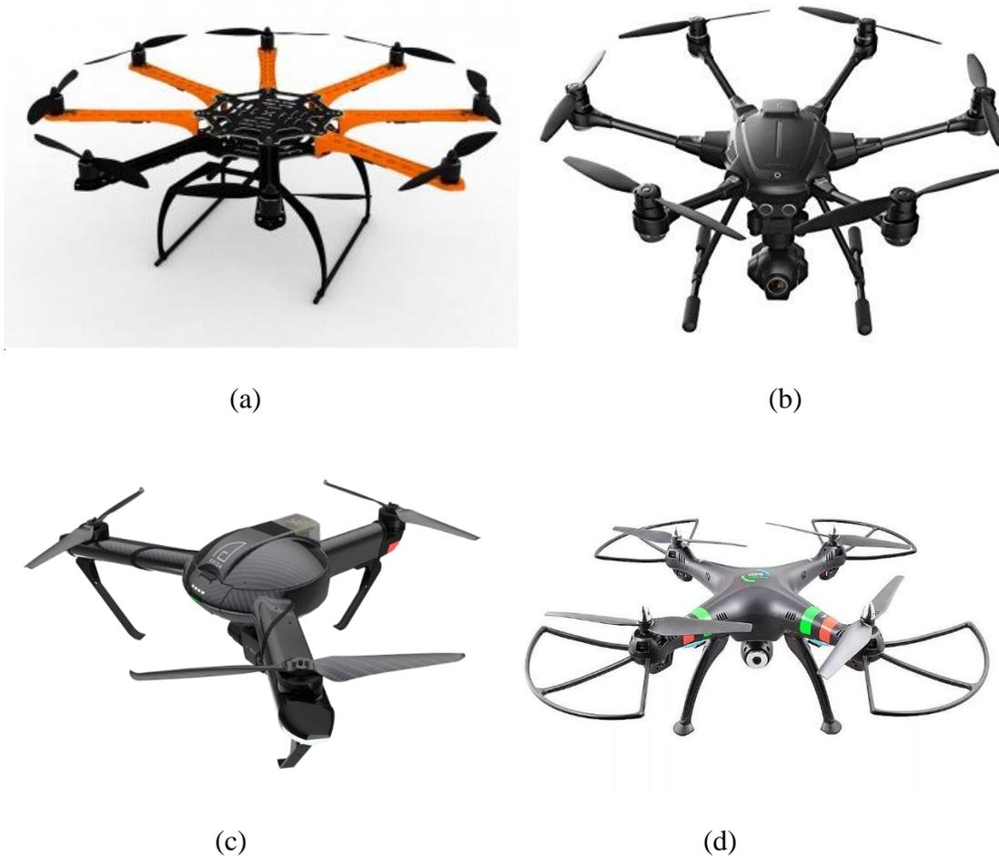
Figura 1.1. Octocóptero (a), Hexacóptero (b), Tricóptero (c), Cuadricóptero (d)
