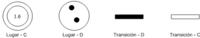
Figura 1.5. Elementos de una RdP híbrida
