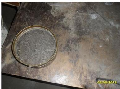
Fig. 3 Tamiz para la separación granulométrica
