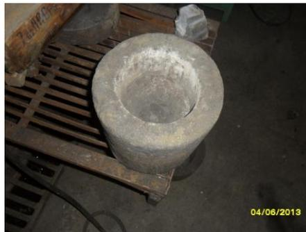
Fig.6 Reactor de grafito para aluminotermia
