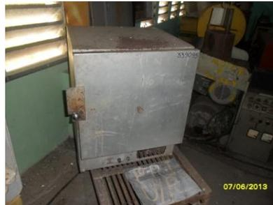
Fig.5 Estufa para el secado de la mezcla
