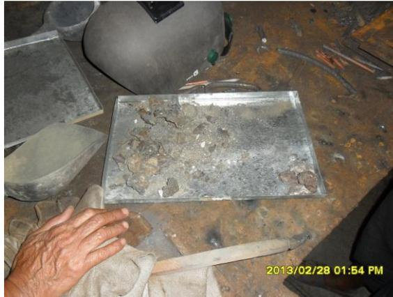
Fig. 8 Muestra de la escoria y el metal por separado
