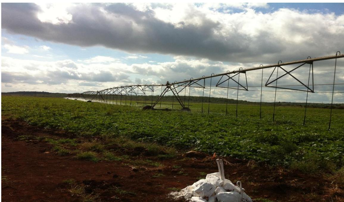
Figura 1. Máquina de riego pivote central eléctrica.
