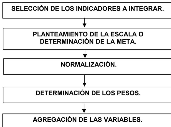
Figura 2.7: Procedimiento para el cálculo del índice global de desempeño ambiental-energético.
