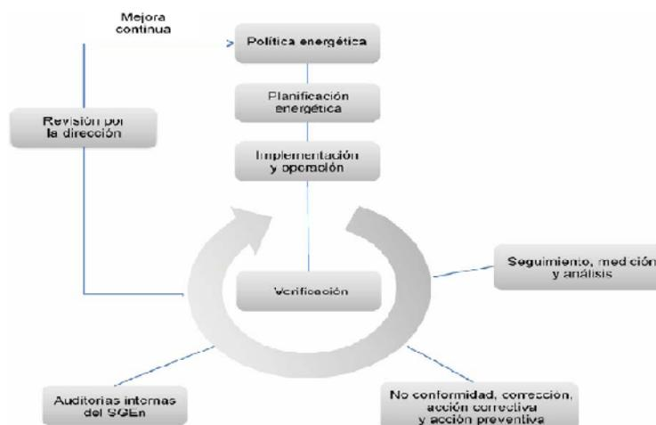
Figura 1.2: Modelo de sistema de gestión de la energía. Fuente ISO 50001:2011.
