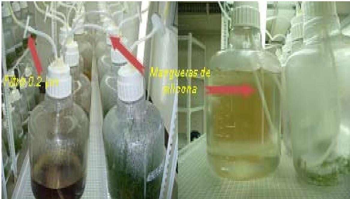
C Figura 3: Conexión de las mangueras y filtros en los SIT
