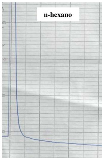
**Figura 2.** Cromatograma de blanco de solvente a las condiciones iniciales de análisis (temperatura de columna 210°C, inyector 230°C, detector 280°C, flujo 38mL/min).
