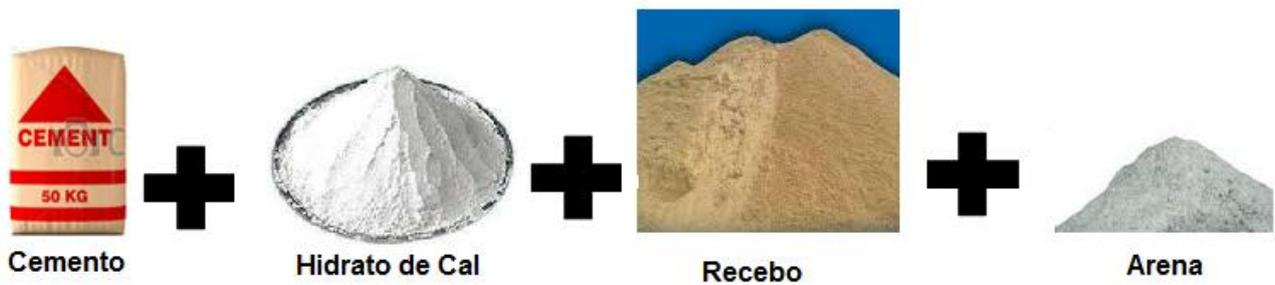
Fig. 49. Mortero aéreo de cemento, hidrato de cal, recebo y arena.
