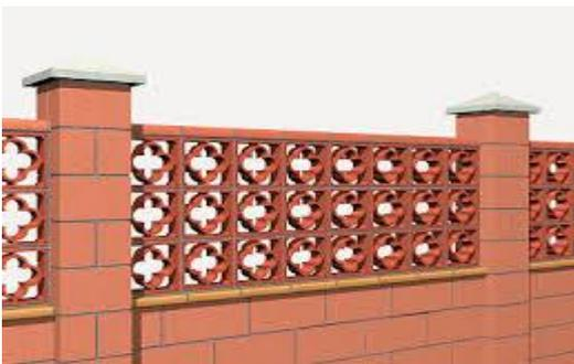
Fig. 9 Muros de celosías de barro.
