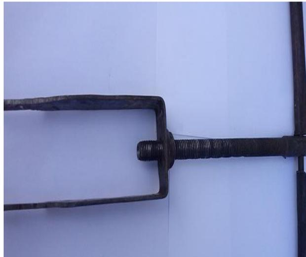
Figura 31: Dispositivo para la alimentación del núcleo del electrodo
