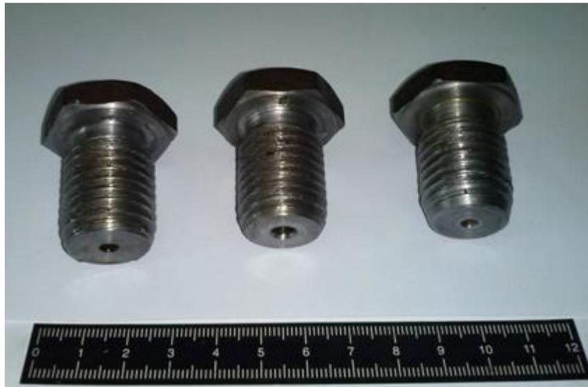
Figura 27: Conductos para la alineación de los electrodos
