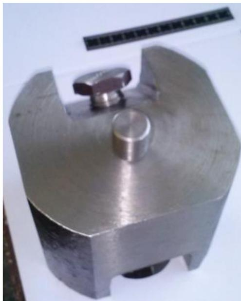
Figura 29: Ensamble completo del dispositivo de extrusión de electrodos
