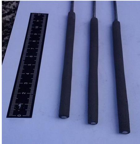
d) Electrodo con recubrimiento homogéneo
