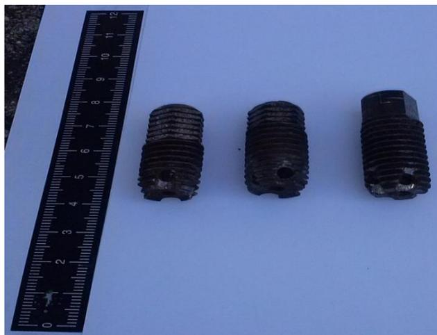
Figura 30: Nuevo prototipo de trefil autocentrante (ver plano del anexo 2)
