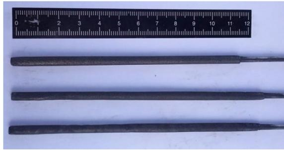
Figura 33: Variante 2. Primera capa depositada con un trefil de diámetro 4,45 mm
