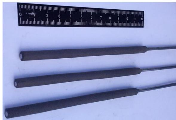
Figura 32: Variante 1. Capa de recubrimiento único del electrodo se emplea un trefil de diámetro 6,5 mm
