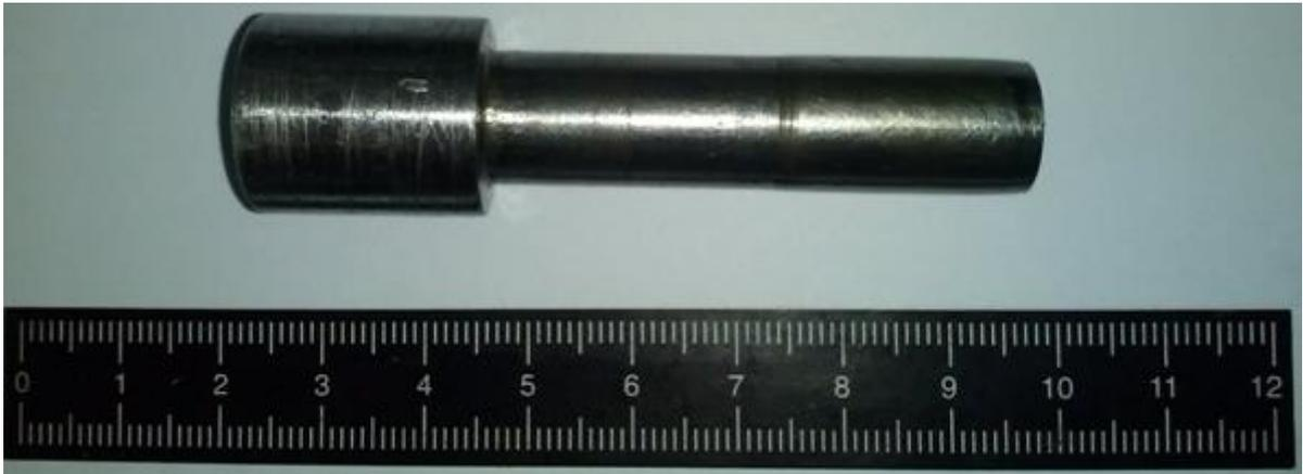
Figura 26: pistón para la compresión de la mezcla
