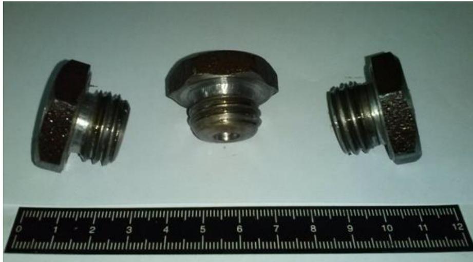
Figura 28: Trefiles para la colocación del recubrimiento al núcleo de los electrodos
