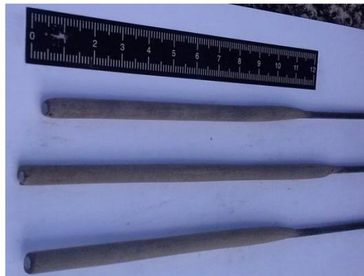
Figura 34: Variante 3. Primera capa depositada con un trefil de diámetro 5,71 mm
