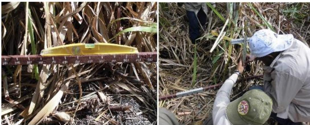
Figura 2.3 Determinación de la variación del perfil del suelo.
