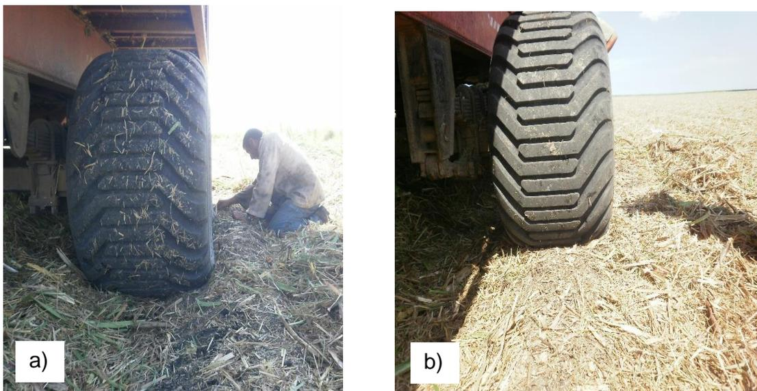
Figura 3.10. Tráfico del autobasculante sobre el cantero. a) Sobre aproximadamente el 50% de la superficie y b) En el 100% del área.
