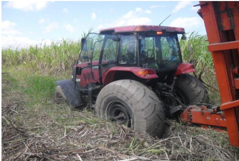
Figura 1.9 Tractor Maxxum CASE IH traficando con exceso de humedad.
