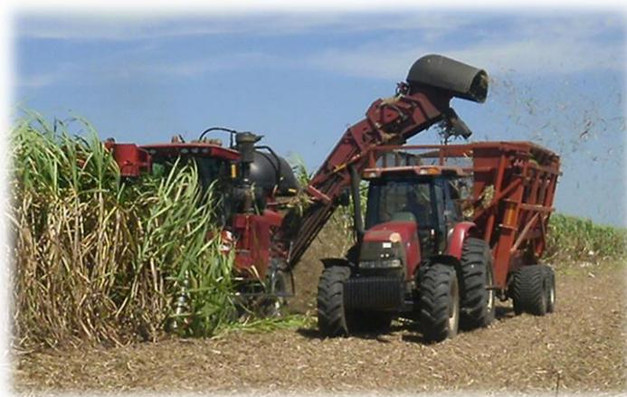
Figura 2.1 Equipos participantes en la cosecha (cosechadora CASE IH 8 800 y el Autobasculante tirado por el Tractor Maxxum Case IH 150).
