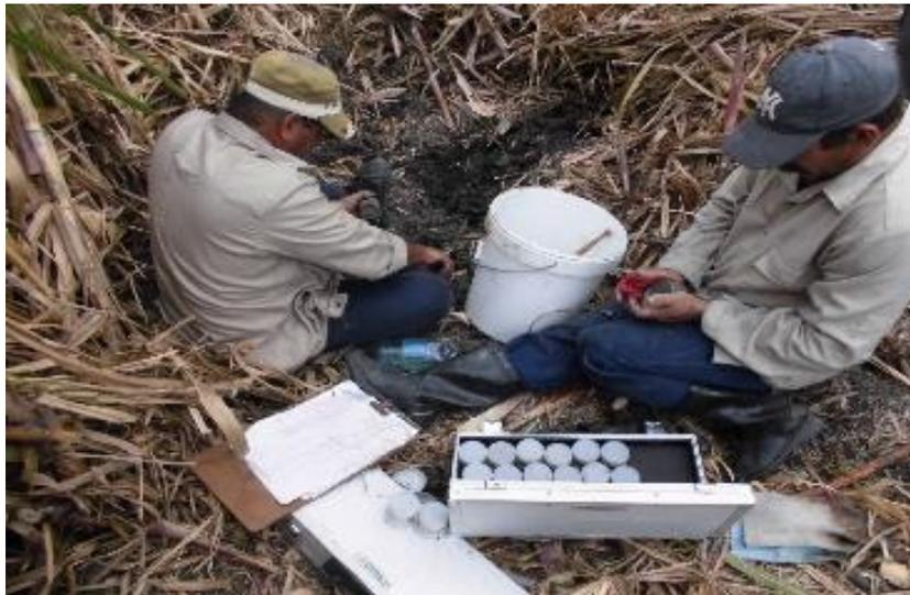
Figura 2.4 Determinación de la densidad aparente.
