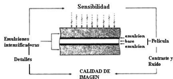
Figura 2 Receptor radiográfico convencional
