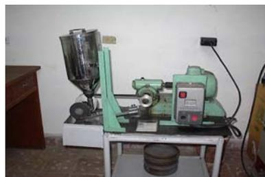
**Fig. 1.4. Máquina para determinar desgaste abrasivo.**
