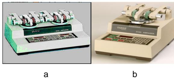
**Fig. 1.2. Medidor de Desgaste por Abrasión:** Taber 5150 (a), Taber 5130 (b).
