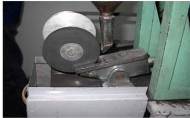
**Fig. 1.5. Vista frontal aumentada de la máquina de desgaste abrasivo.**
