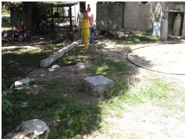
Figura 3. Pobre instalaciones de tanque séptico, insuficiente y con malos registros.
