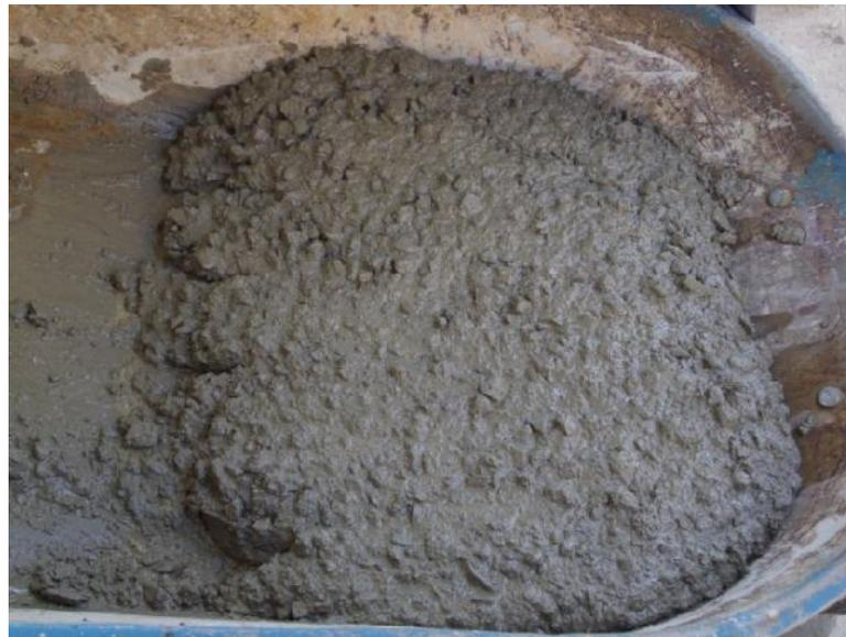
**Fig. 3.2. Hormigón de buena consistencia**
