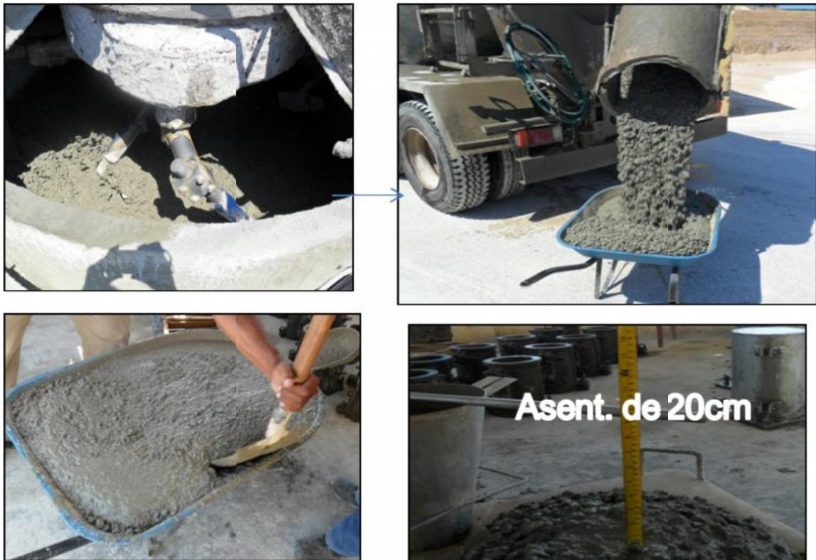
**Fig.3.8. Observaciones de los cambios en las reología del hormigón**
