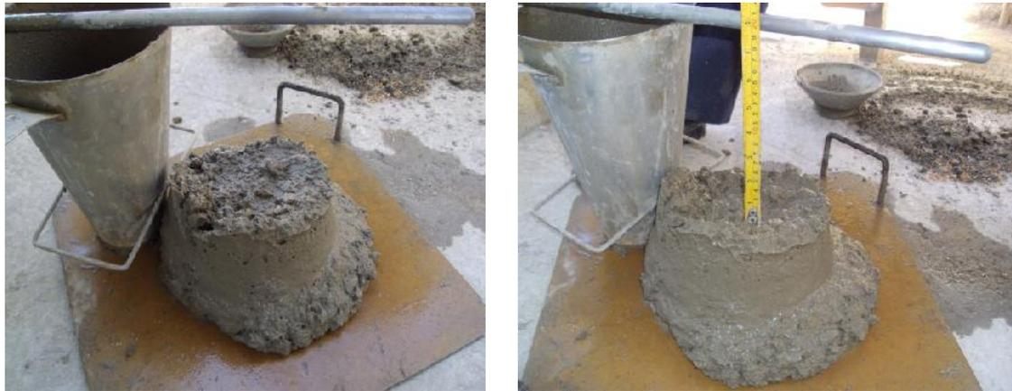
**Fig-2.2. Asentamiento en el Cono de Abrams**
