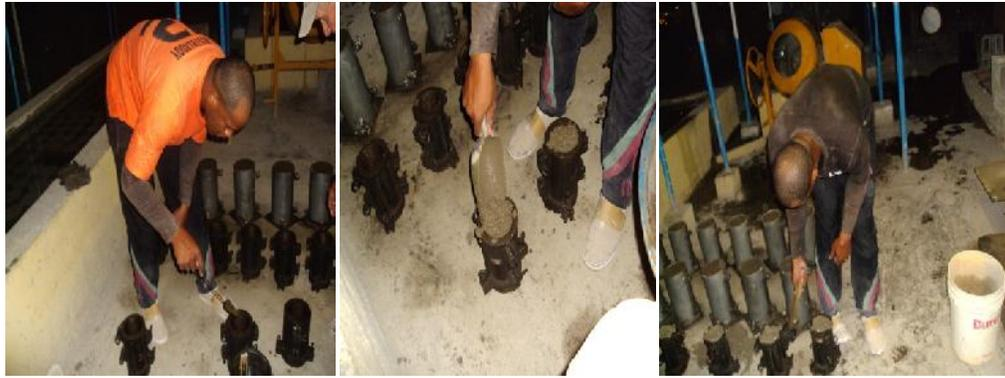
**Fig.2.3. (a) Preparación (b) Llenado (c) Compactación**
