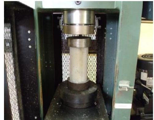
**Fig.2.5 Ensayo de resistencia a compresión (Prensa)**
