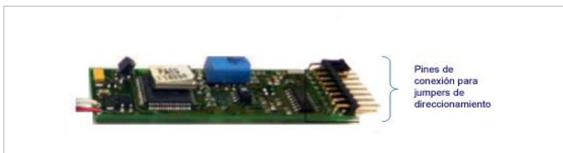
Figura 2.1. Circuito interno del transductor TP204M (std).
