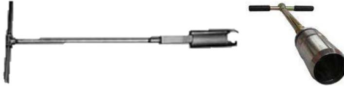
Figura 6. Cilindro muestreador.
