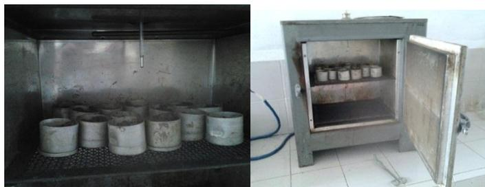
Figura 8. Secado de las muestras en la estufa.
