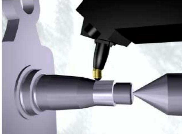
**Figura 3 Herramienta del bruñido por bolas colocada hidrostáticamente.**
