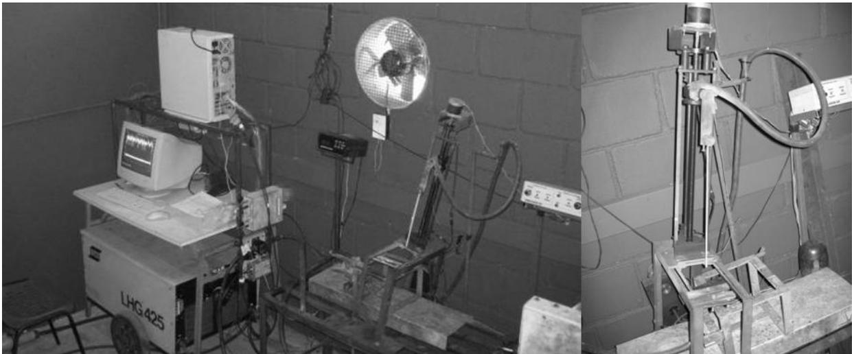
**Figura 2.2. Instalación experimental para la soldadura mecanizada con electrodo revestido.**
