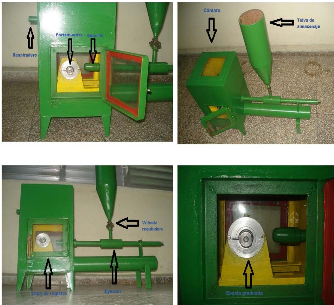
Figura 2.4. Dispositivo de ensayo al desgaste erosivo.
