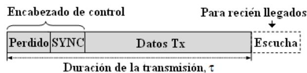
Figura 2.11: Estructura del paquete de datos.
