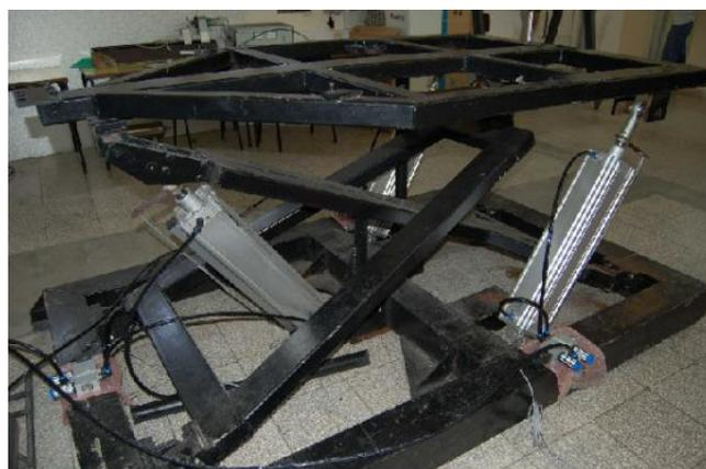
Figura 2. Plataforma neumática de tres grados de libertad
