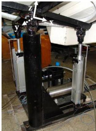
Figura 1. Plataforma neumática de 2GDL.
