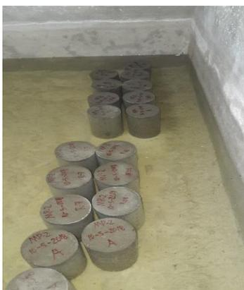
**Figura 10** Tanque de curado
