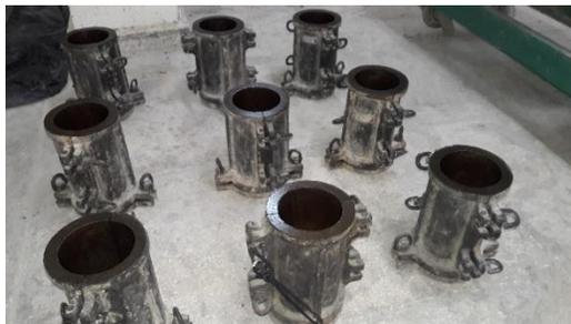
**Figura 9** Moldes de probetas cilíndricas 100 x 200 mm
