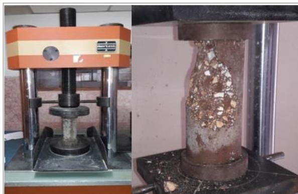
**Figura 11** Ensayo de resistencia a compresión
