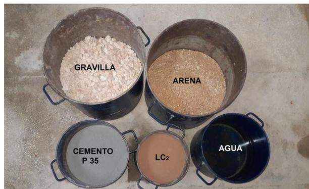
**Figura 7** Materias primas para el hormigón
