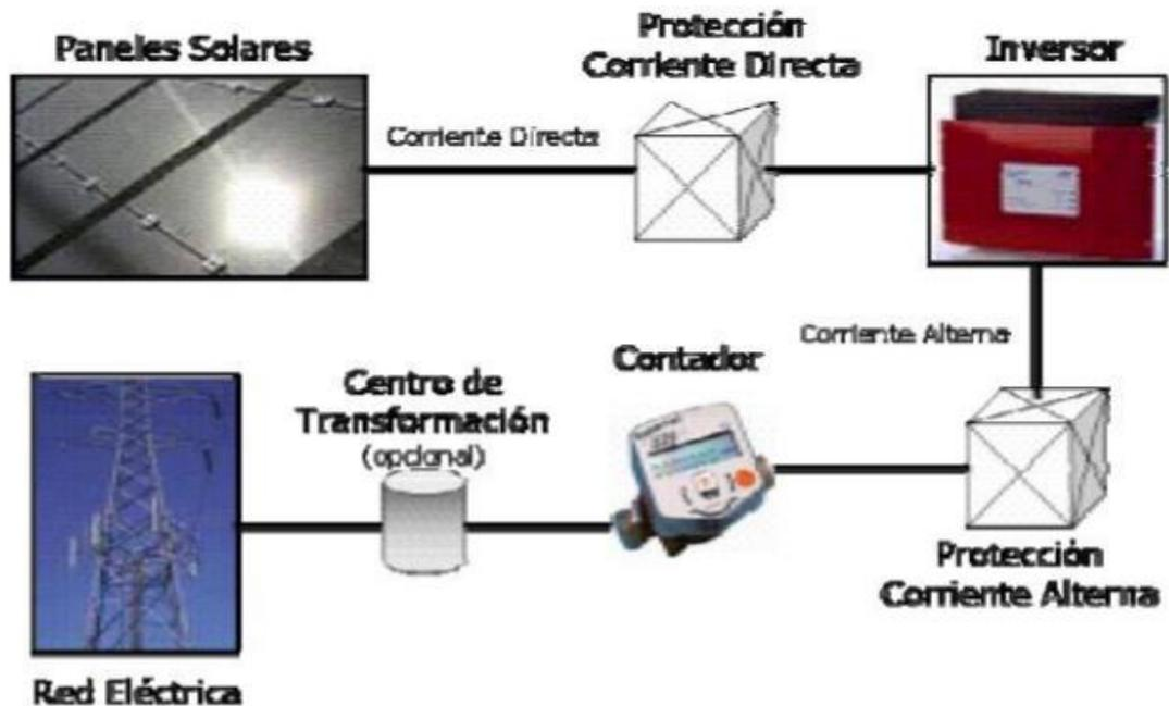
Fig.-1.1 Esquema general de una instalación solar fotovoltaica con conexión a red.(Rodríguez Barrera, 2017)
