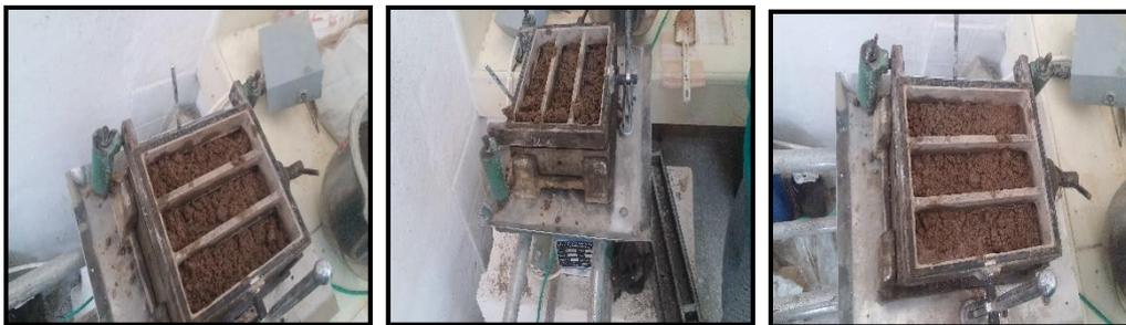
**Figura 2.10.** Elaboración de las probetas utilizadas para los ensayos de resistencia a compresión.
