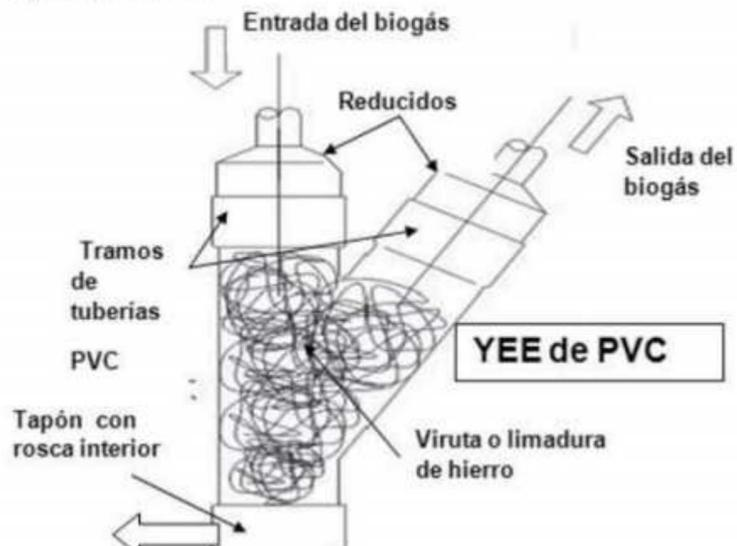
Fig. 1.3. Filtro para eliminación de (H<sub>2</sub>S) en biodigestores sencillos. Fuente: Biodigestores simples, Secadores y Calentadores solares. 2014.
