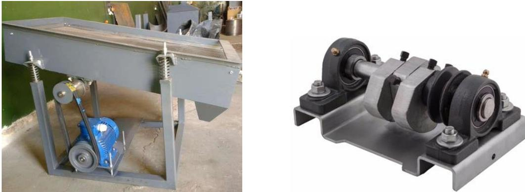
**Figura 1.12: Zaranda vibratoria y mecanismo excéntrico.**
