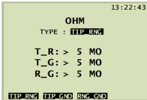
Figura 2.6 Medición de resistencia de aislamiento.
