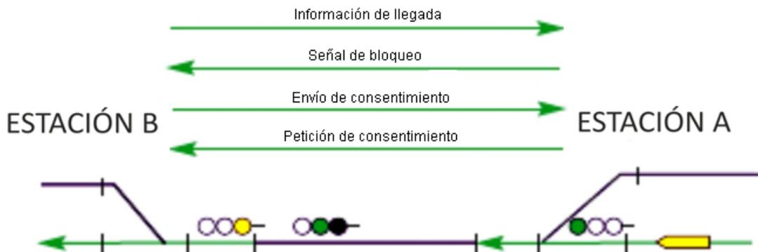
Figura 1.1: Protocolo para la comunicación del sistema de BSA entre estaciones.
