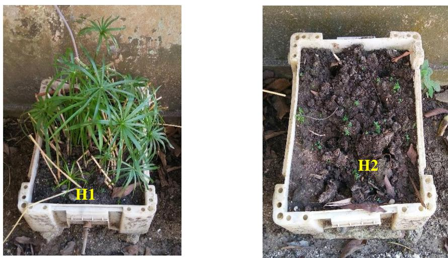
**Figura 2.1.** Humedales subsuperficiales a escala de laboratorio
