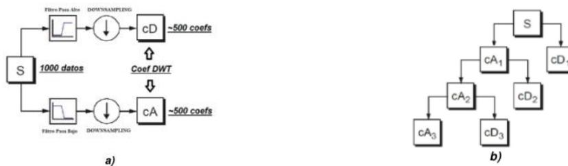
Figura 2.4. Descomposición DWT. a) Proceso de filtrado: aproximaciones y detalles, b) Árbol de descomposición Wavelet. Tomado de (Misti, et al., 2007)
