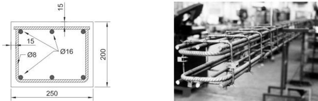
*Fig.3.10. Sección transversal de la viga y colocación del acero de refuerzo. Tomado de ( Maeck , 2003).*
