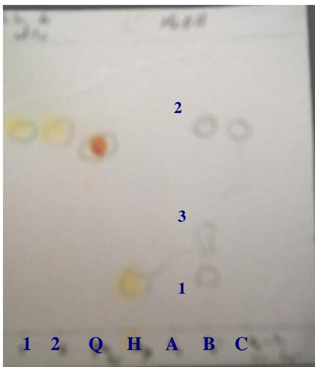
*Fig. 8 Desarrollo cromatográfico de las fracciones obtenidas en la CCDp (A, B, C) con los patrones de flavonoides.*
