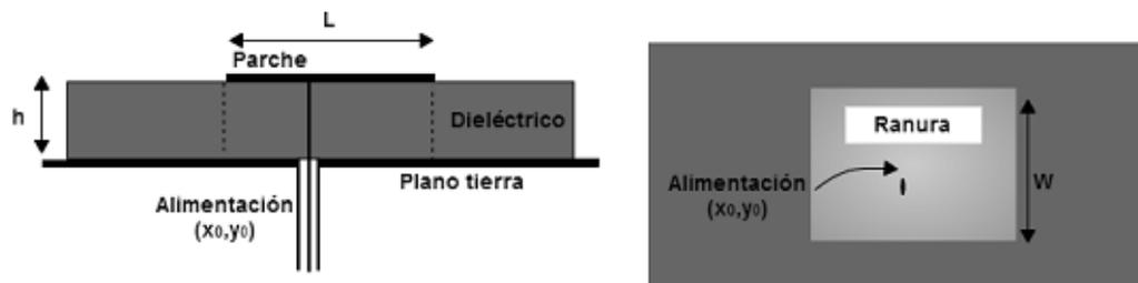
Fig. 2.4 Antena *Microstrip* Parche Rectangular Original y con Ranura
