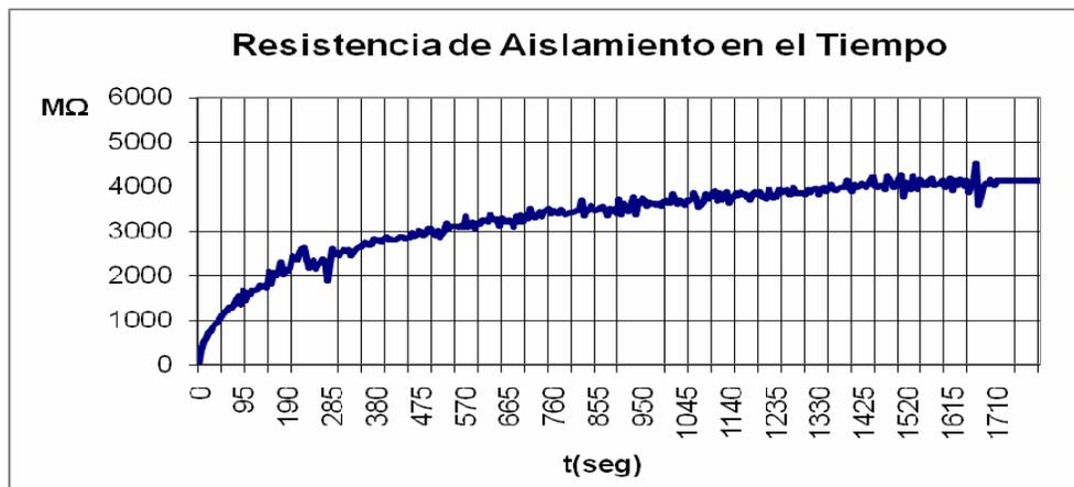
Fig. 3.6 Comportamiento de la estabilidad de la resistencia en el tiempo, G-4 fase B. Después del secado.
