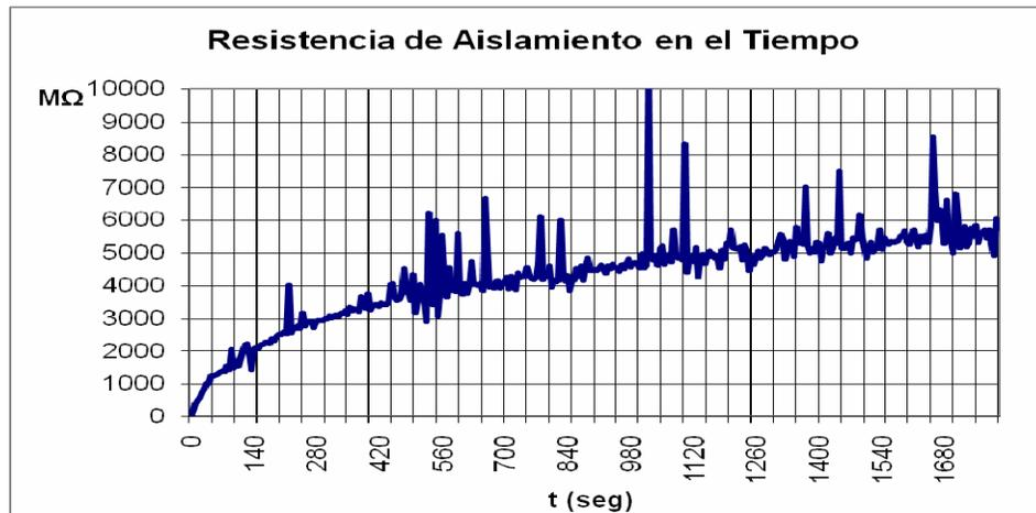
Fig. 3.3 Comportamiento de la estabilidad de la resistencia en el tiempo, G-4 fase B.
