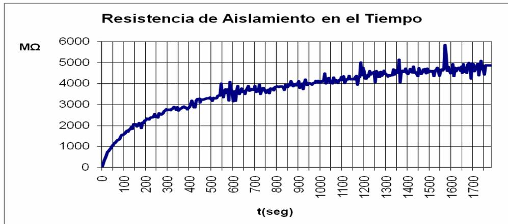
Fig. 3.5 Comportamiento de la estabilidad de la resistencia en el tiempo, G-4 fase A. Después del secado.
