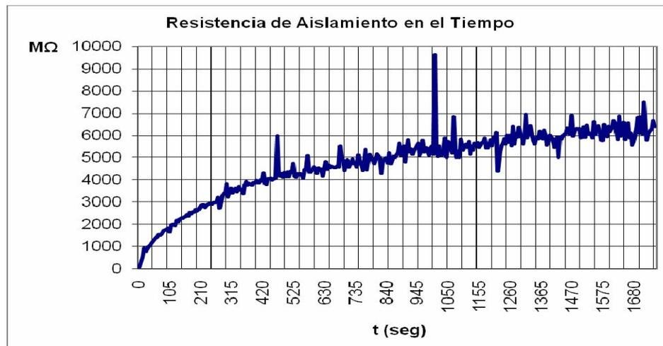
Fig. 3.2 Comportamiento de la estabilidad de la resistencia en el tiempo, G-4 fase A.
