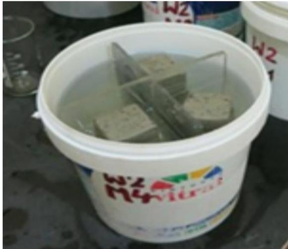
Figura 2.4: Prismas colocados en agua(Braun, 2016).
