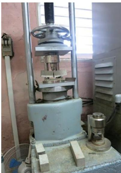
Figura 2.3 Máquina de ensayo flexión(Braun, 2016) .
