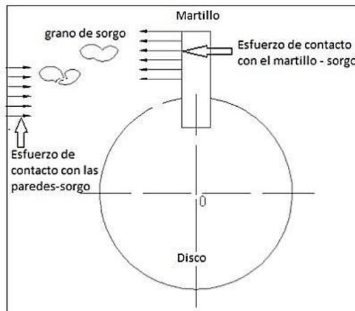
Figura 3: Esfuerzo de contacto martillo-sorgo, pared-sorgo
