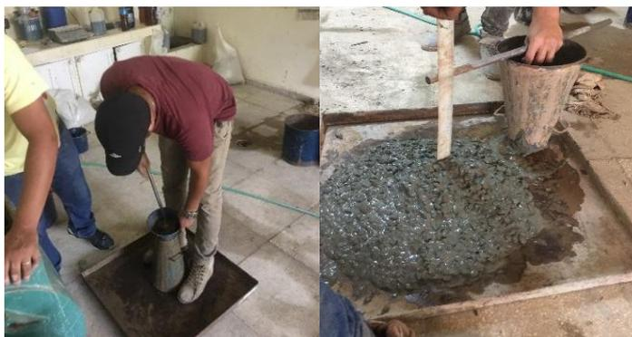
**Figura 3.2** Medición del asentamiento por el cono de Abrams. (Fuente: Tesis de Carlos Mario).
