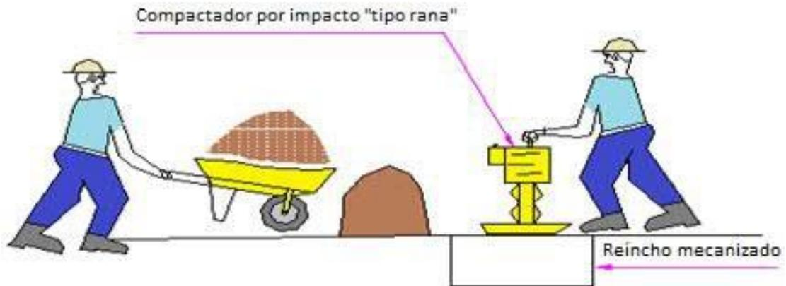
**Figura 10: Rehinchado entre vigas.**
