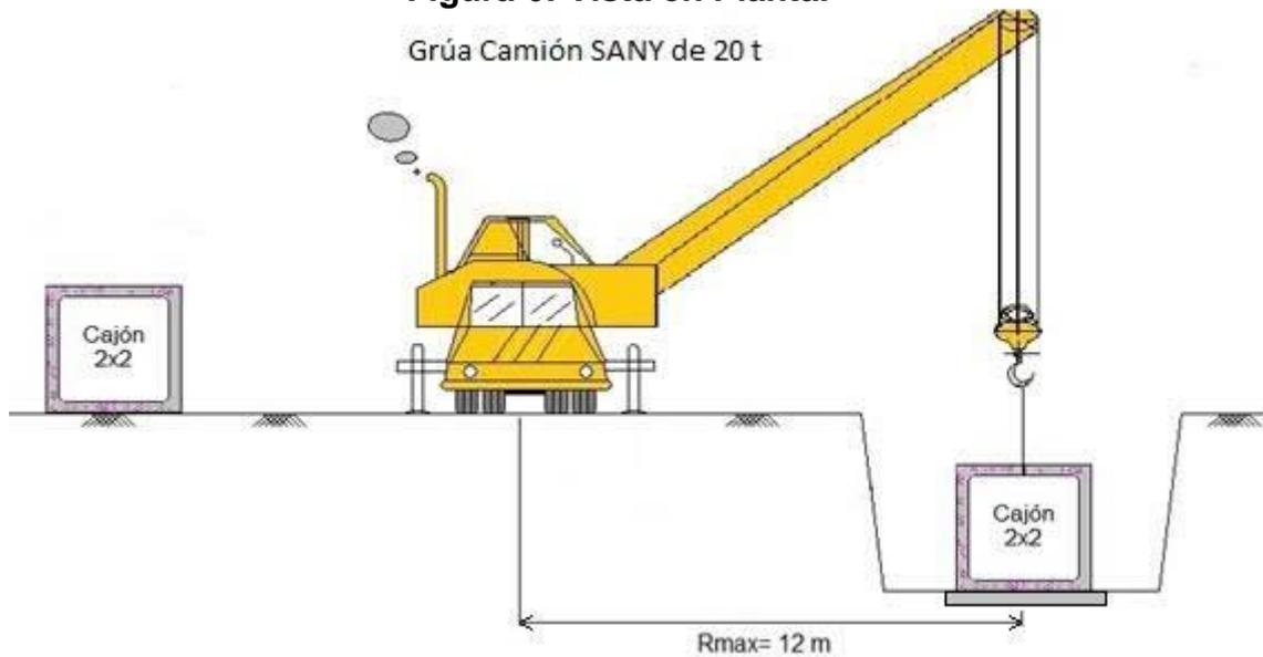
**Figura 7: Sección Transversal**
