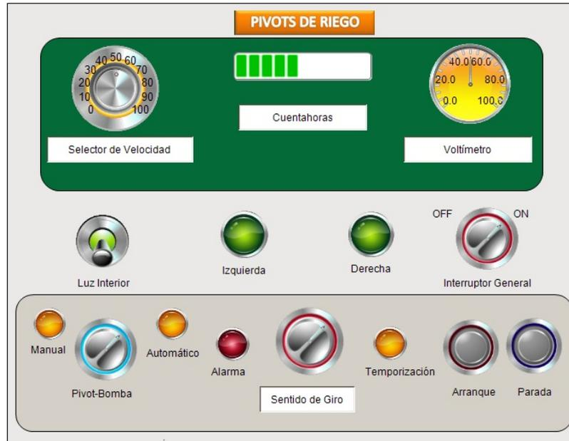
Figura 4. Interfaz web para la supervisión y control del riego en máquinas de pivote central (elaboración propia).
