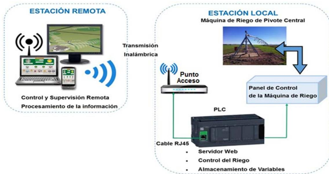
Figura 3. Arquitectura para el control y supervisión remota de máquina de riego de pivote central (elaboración propia).
