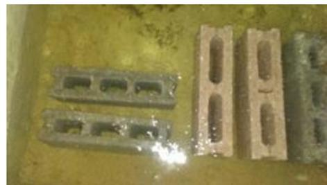
Fig.2.22 b) Bloques sumergidos en agua
