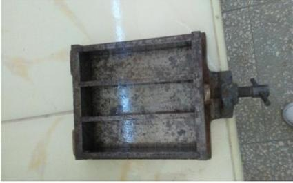
Fig.2.16 a) Moldes de las probetas
