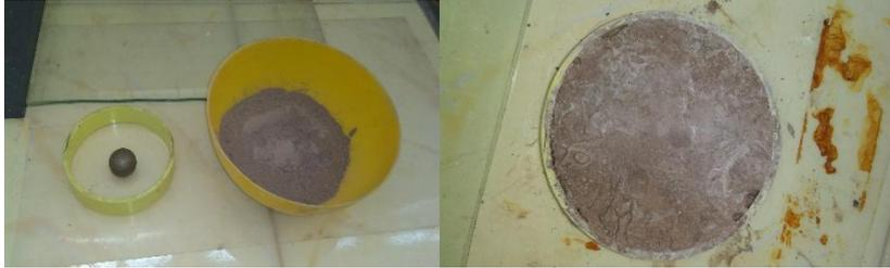
Fig.2.10 Ensayo de la huella
