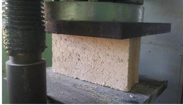
Fig.2.21 Ensayo a compresión del bloque fabricado con LC<sup>3</sup>
