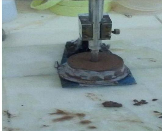
Fig.2.14 Ensayo de consistencia normal
