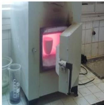
Fig.2.12 b) Arcilla calcinada a 850 °C
