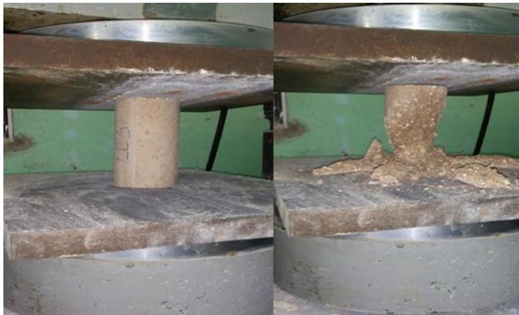
**Fig.3.11: Ensayo de resistencia a la compresión a las probetas de hormigón**
