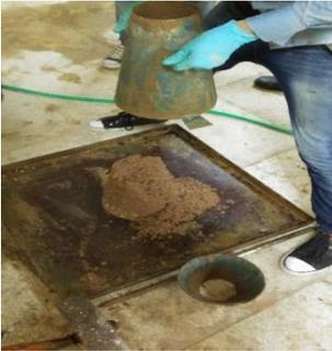
Fig.2.24 Medición del asentamiento
