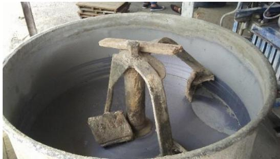
Fig.2.20 Mezcladora horizontal.
