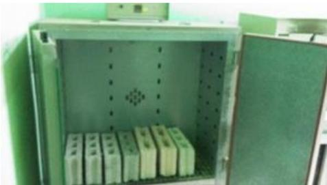
Fig.2.22a) Bloque secado a 110 °C
