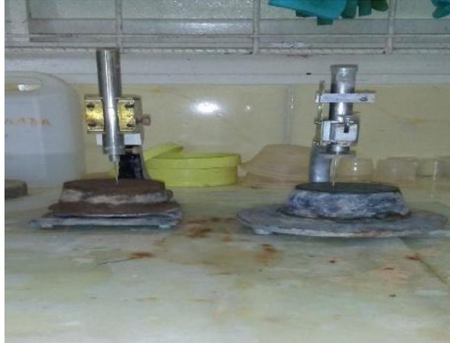
Fig.2.15 Tiempo de Fraguados mediante la aguja de Vicat
