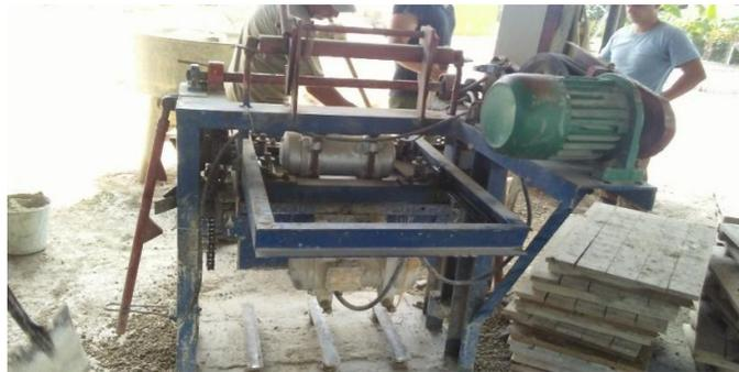
Fig.2.19 Máquina Vibrocompactadora marca Jinly modelo QTJ4-45
