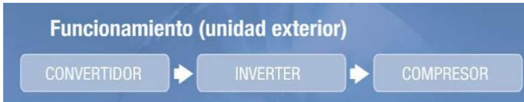
Figura 13. Diagrama de flujo del sistema *Inverter*.
