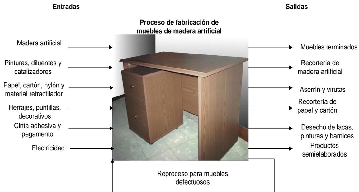
Figura 2.2. Balance de masa y energía. (Fuente: Elaboración propia)
