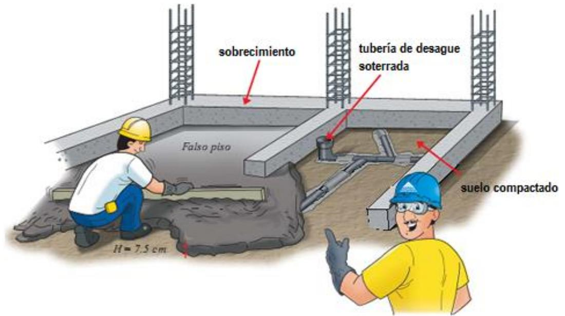
**Figura 1.1 - Instalaciones de evacuación soterradas**
