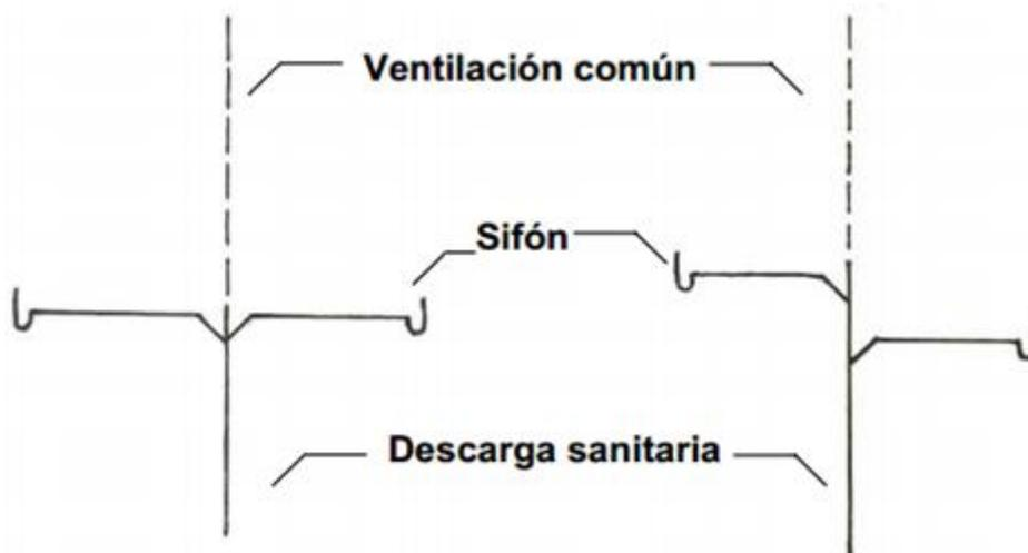
Figura 1.37 – Variante de ventilación unitaria o común
