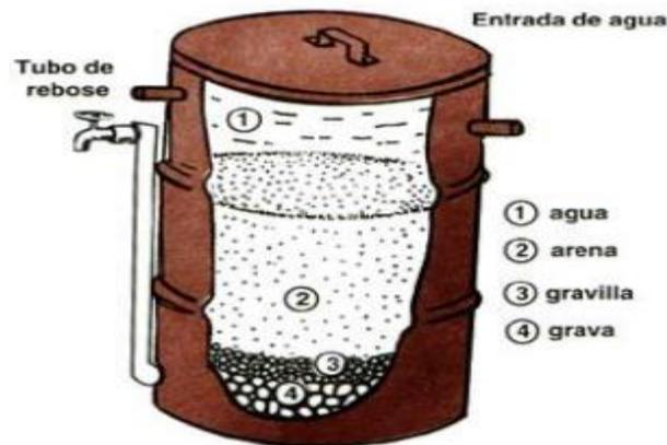
Figura 1.2. Componentes básicos de un filtro de arena. Fuente: (Aguilar, 2009).
