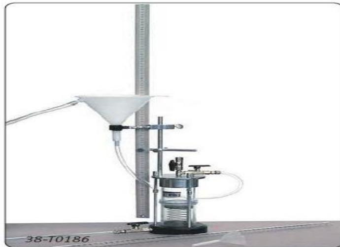
Figura 2.7. Permeámetro combinado, modelo k-605 AI.
