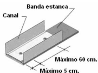
Espaciamiento que deben tener los tornillos en la fijación de la canal y la colocación de la banda estanca. Fuente: PLADUR LAFUENTE.
